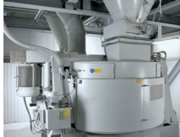
Intensywny mieszalnik do przygotowania homogenicznego zarobu
