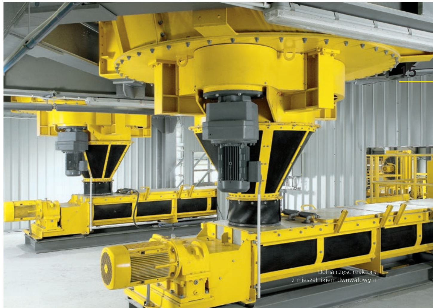
Intensywny mieszalnik do przygotowania homogenicznego zarobu
