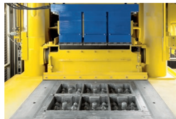
Stół formy z wymiennymi wkładami
