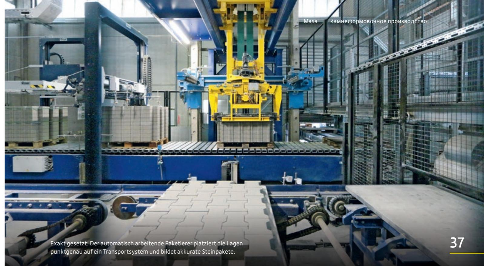
Exakt gesetzt: Der automatisch arbeitende Paketierer platziert die Lagen punktgenau auf ein Transportsystem und bildet akkurate Steinpakete.
