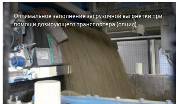
Оптимальное заполнение загрузочной вагонетки при помощи дозирующего транспортера (опция)
