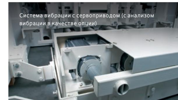
Система вибрации с сервоприводом (с анализом вибрации в качестве опции)
