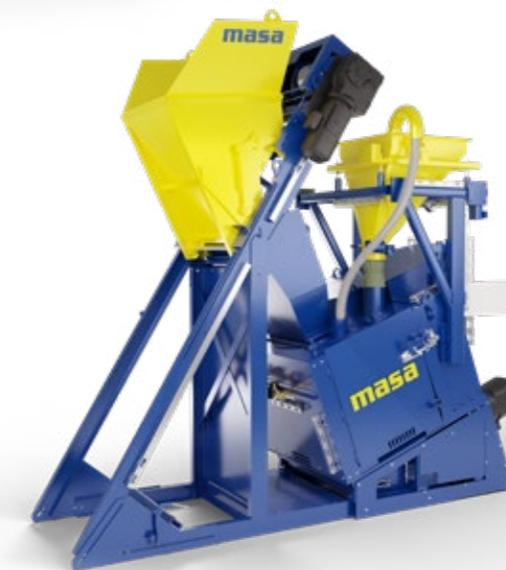
Мал да удал: наш смеситель S 350/500 идеально подходит для производства бетона для лицевого слоя, придающего уникальный вид продукции, например, тротуарной плитке. В комбинации со смесителем линейки РН наш компактный смеситель может применяться в производстве бетонных элементов для садового или ландшафтного строительства.
