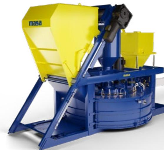
Unser Größter, der PH 3000/4500, eignet sich hervorragend für die hochvolumige Kernbetonproduktion in kurzen Zyklen. Sein volles Potenzial als Hochleistungsmischer stellt er in der Betonherstellung für Block- Wand- oder Bordsteine unter Beweis.
