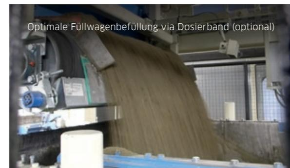
Optimale Füllwagenbefüllung via Dosierband (optional)
