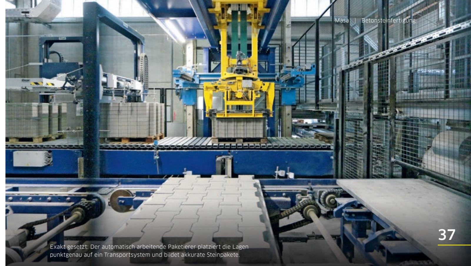
Exakt gesetzt: Der automatisch arbeitende Paketierer platziert die Lagen punktgenau auf ein Transportsystem und bildet akkurate Steinpakete.
