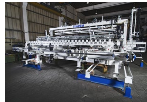
Сделано в Германии: «зеленый» стол для деления массива в монтажном цехе в г. Порта Вестфалика перед отгрузкой
