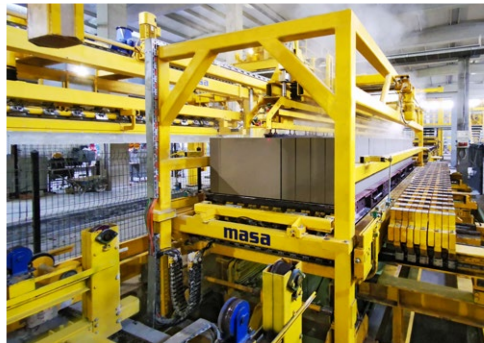
«Зеленый» стол для деления массива перед запариванием с регулируемыми разделительными балками
