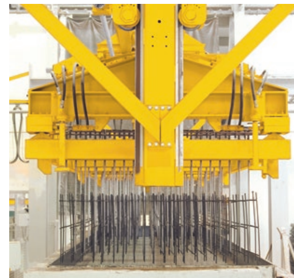
Установка арматурных каркасов в форму
