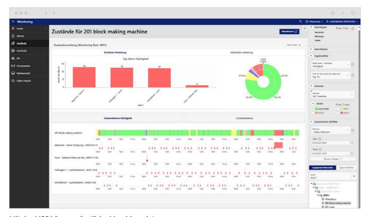
Mit der MSC können sämtliche Maschinendaten gefiltert und ausgewertet werden: häufigste Alarme, statistische und grafische Verteilung der Zustände sowie Zustandshistorien.
